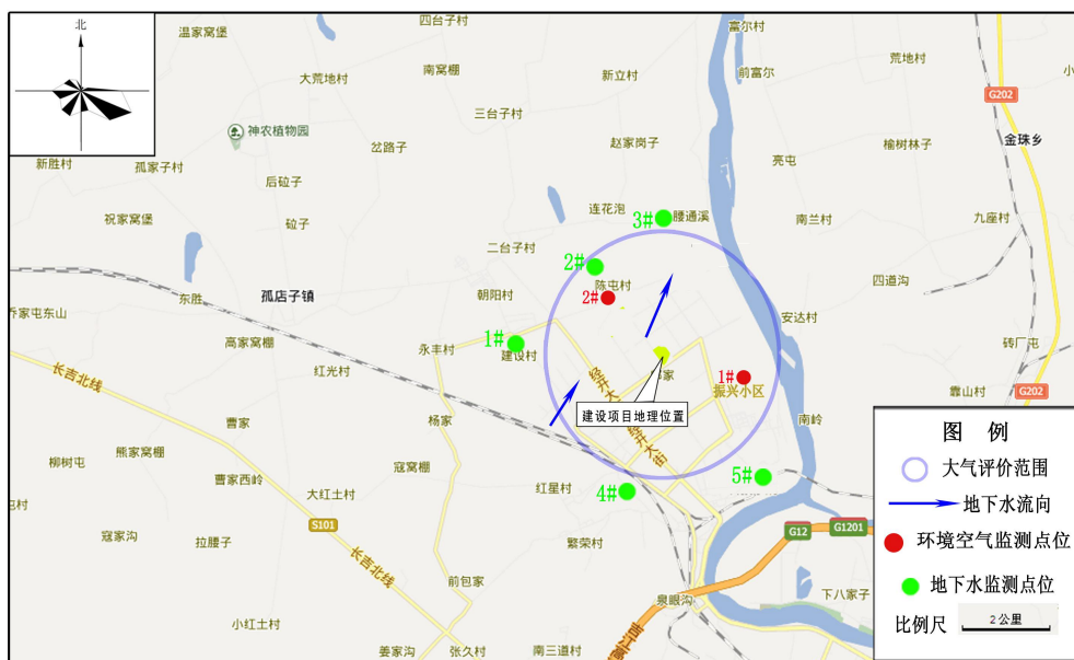
图4-2 环境空气、地下水现状监测布点示意图
