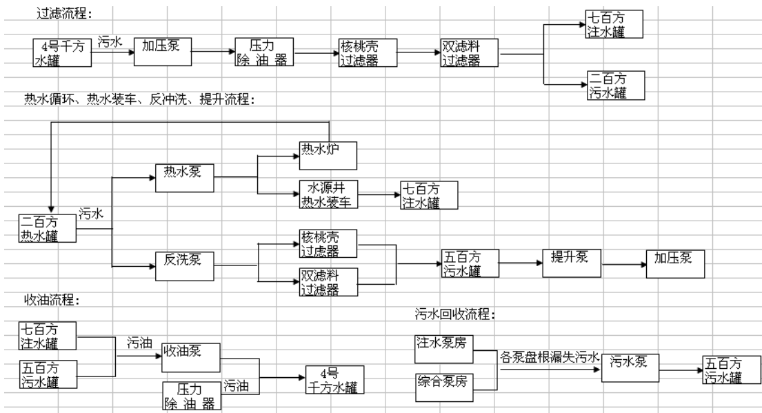
图 5-8 英台采油厂油气处理二站污水处理工艺流程示意图
