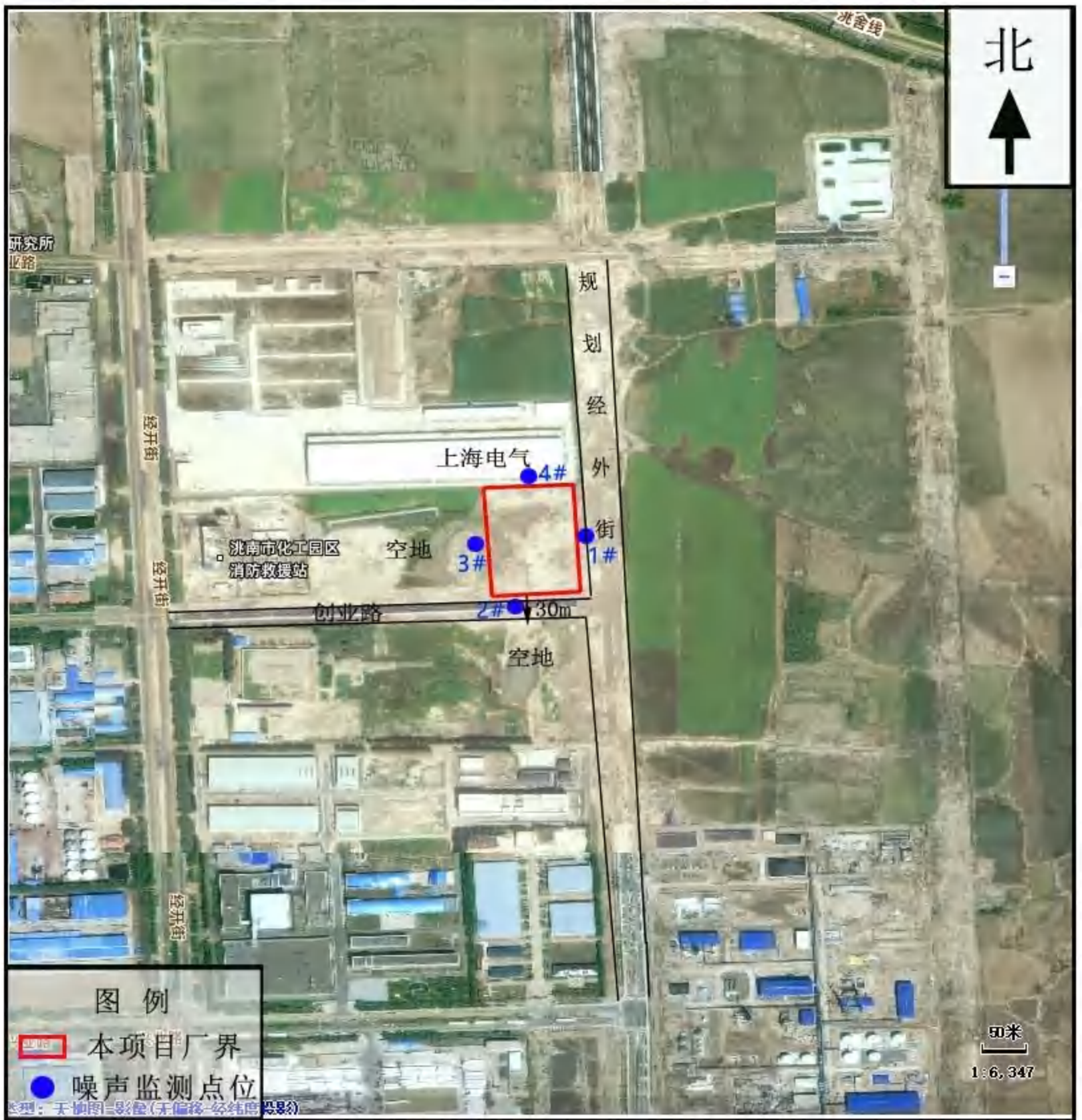
附图3-1 本项目卫星图、四周环境状况分布及噪声监测点位图
