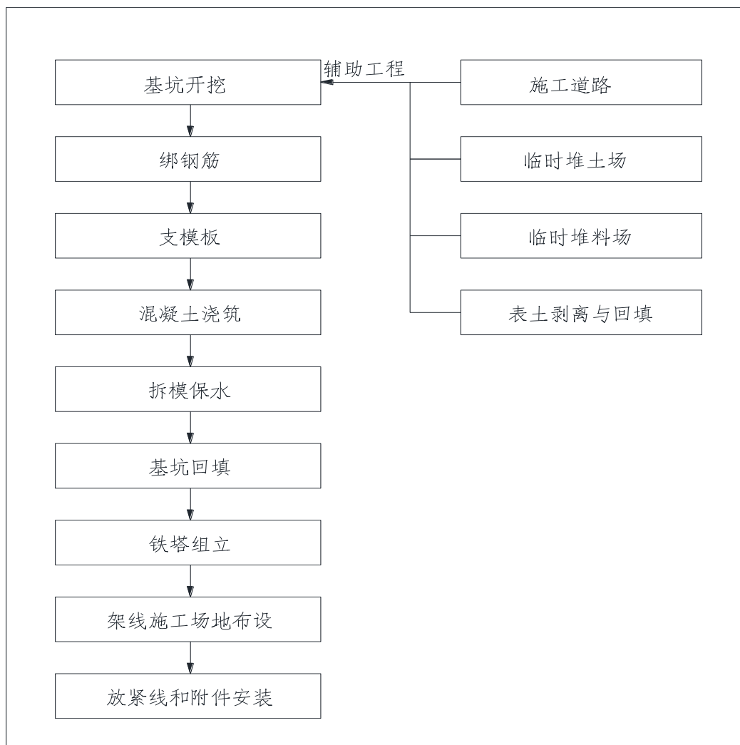
图 3.1-3 输电线路施工工艺流程图
