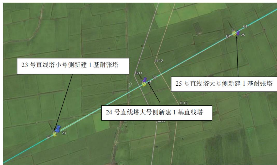
图 3.1-2 500kV 甜乐 I、II 线改造方案示意图
