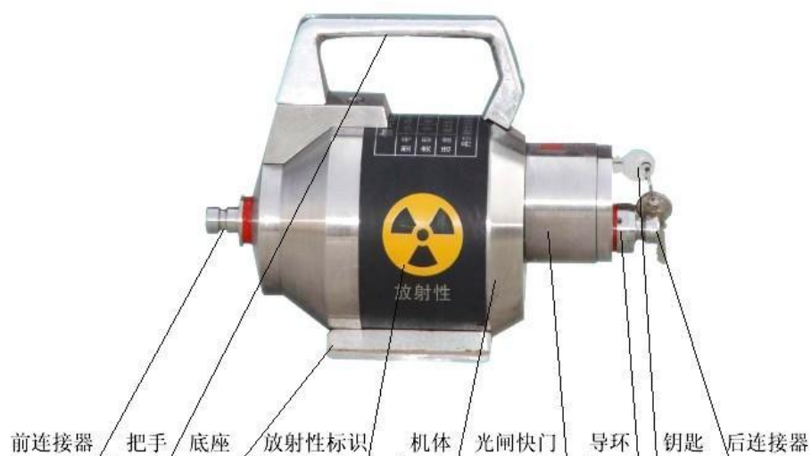
图 9-2 源屏蔽容器（贮源容器）外部结构组成示意图
