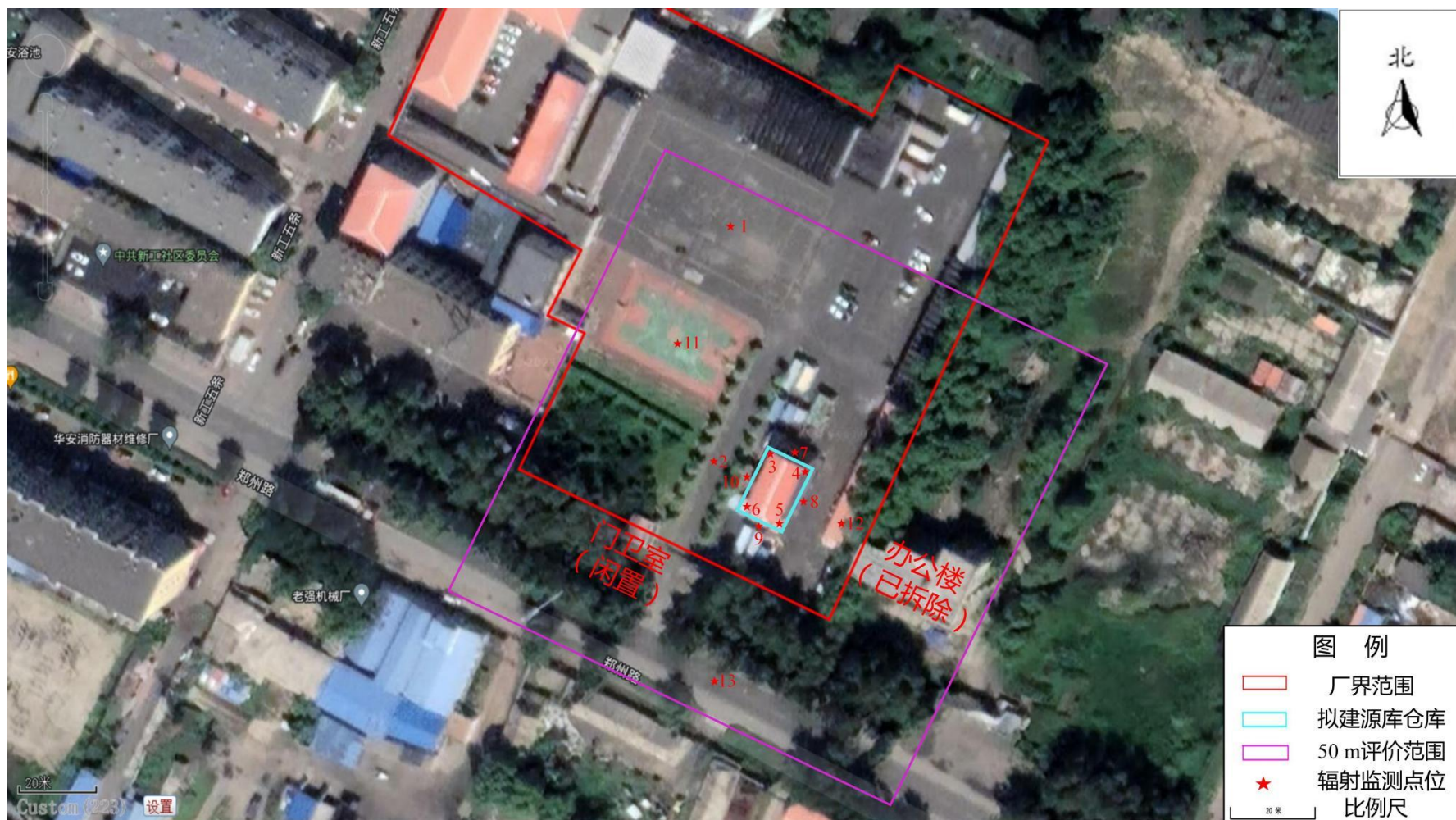
附图 4 环境 \gamma 辐射剂量率监测布点示意图
