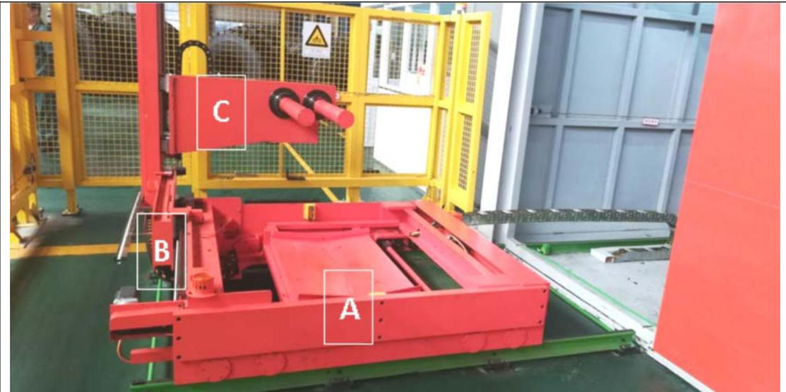
图 9-3 X 光机运送车（XTI-2035G 型工程胎 X 射线轮胎检测系统）
