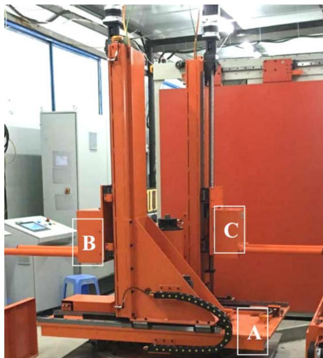
图 9-4 装卸胎机构（XTI-2035G 型工程胎 X 射线轮胎检测系统）
