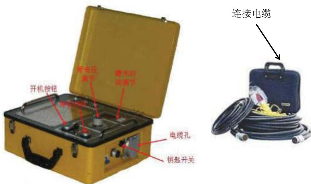
图 9-1 常见 x 射线探伤机控制箱及连接电缆
