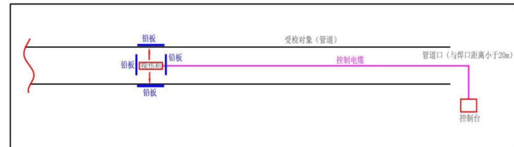
(2) 周向型 X 射线探伤机摆位图 (俯视图)
