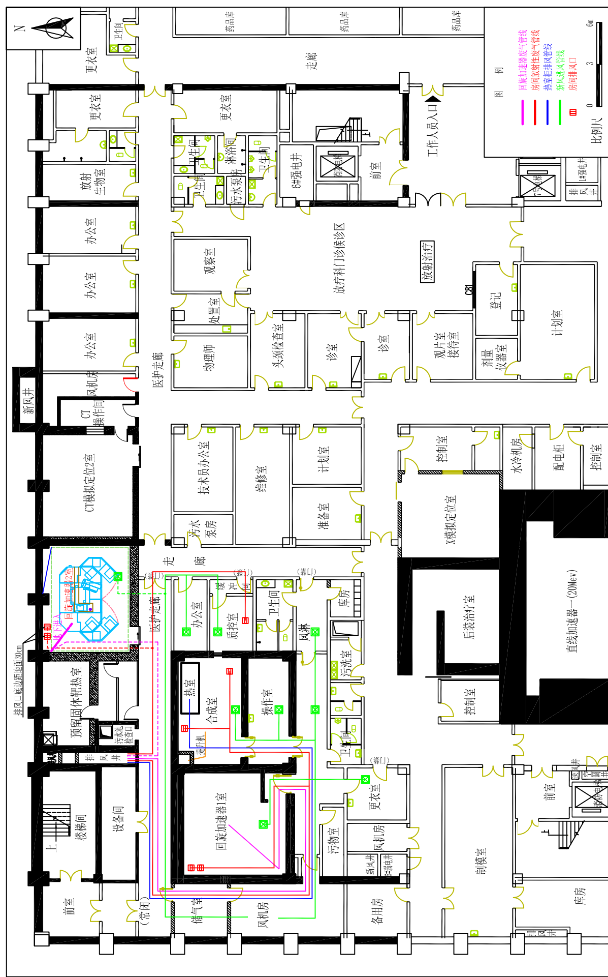
附图9 本项目回旋加速器2室所在区域排风管线示意图
