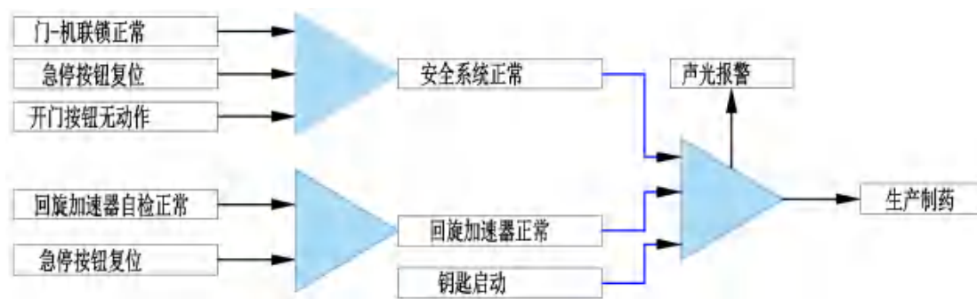
图 10-1 回旋加速器机房联锁装置逻辑关系示意图
